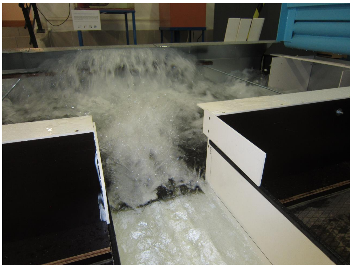
Obr. 69 Odtlačení proudu za hranu konce skluzu při průtoku Q_{1\,000} = 1411 \text{ m}^3/\text{s}
