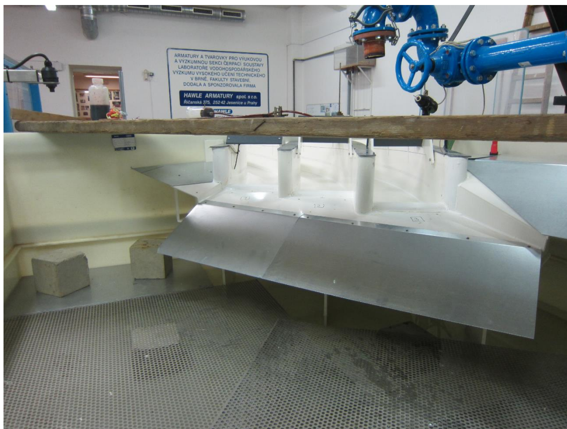
Obr. 15 Uspořádání perforovaných plechů nade dnem uklidňovací nádrže
