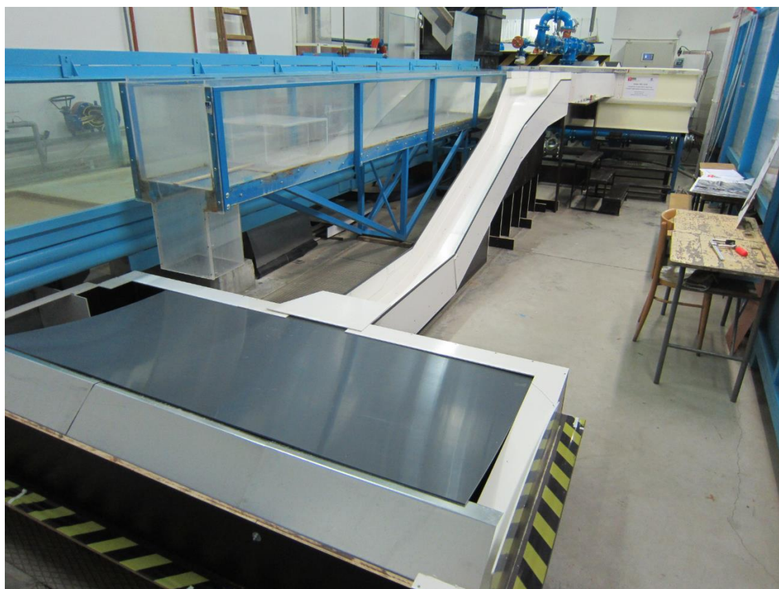
Obr. 14 Protiproudňí pohled na model VD Orlík, v popředí zakrytá odtoková nádrž pro eliminaci výstřiků
