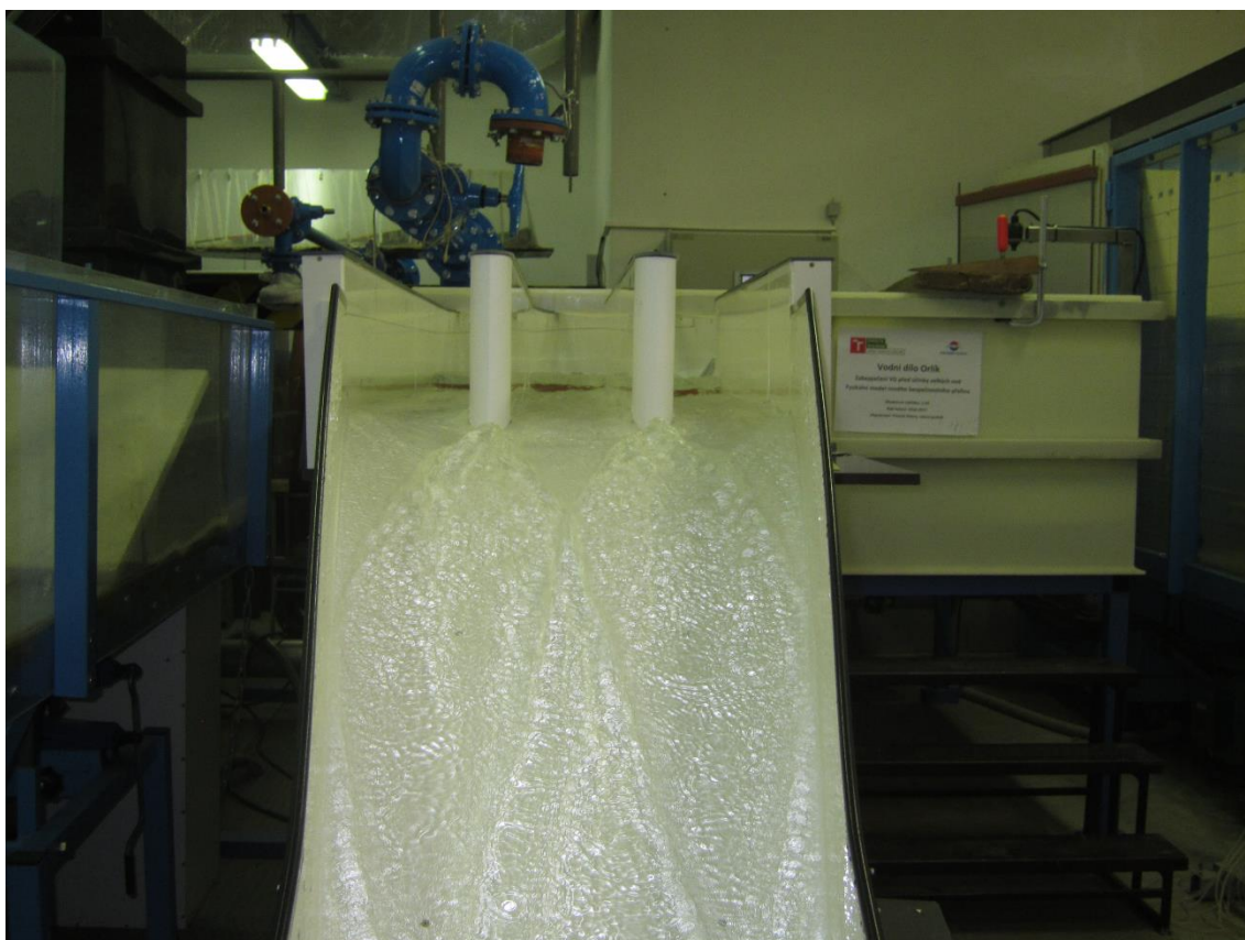
Obr. 56 Protiproudňí pohled na symetrické zatížení počátku otevřené části skluzu při průtoku 450 \text{ m}^3/\text{s}
