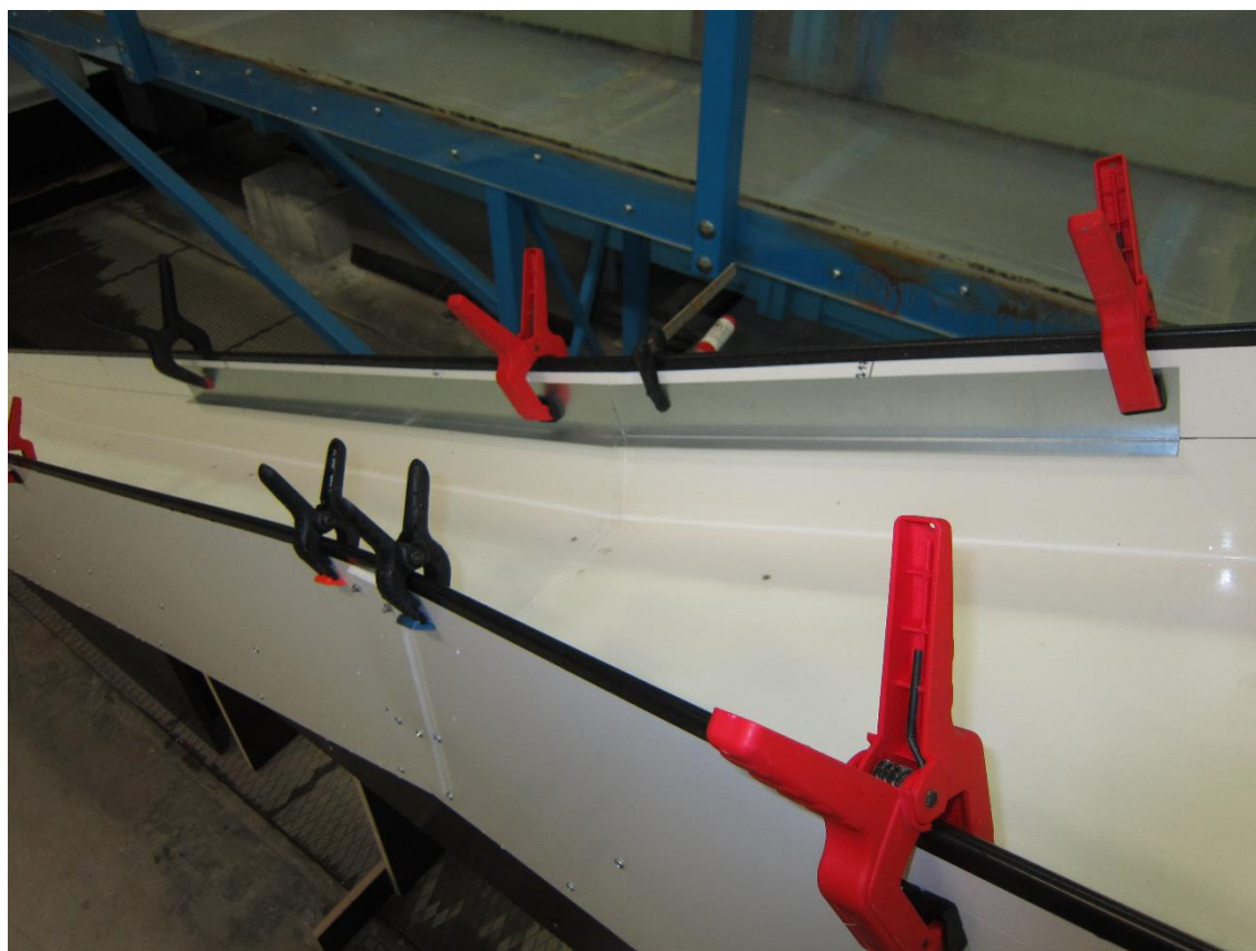
Obr. 67 Jedna z variant instalace liniových usměrňovačů
