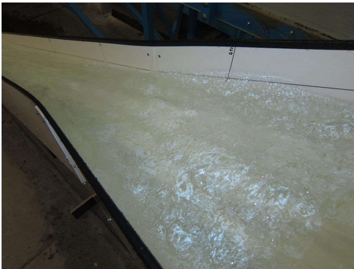
Obr. 58 Počátek přelití pravé stěny skluzu ve staničení 175,00 při průtoku Q_{10\,000} = 1766 \text{ m}^3/\text{s}
