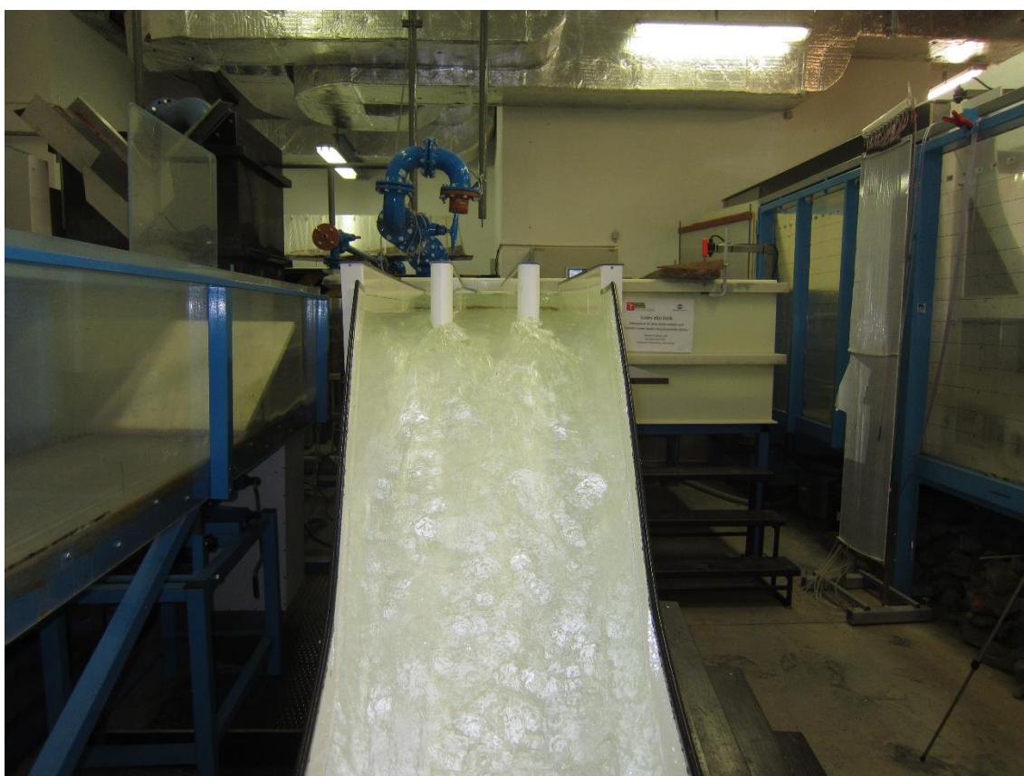
Obr. 57 Protiproudňí pohled na hladinové deformace za koncovými pilíři při průtoku Q_{10\,000} = 1766 \text{ m}^3/\text{s}
