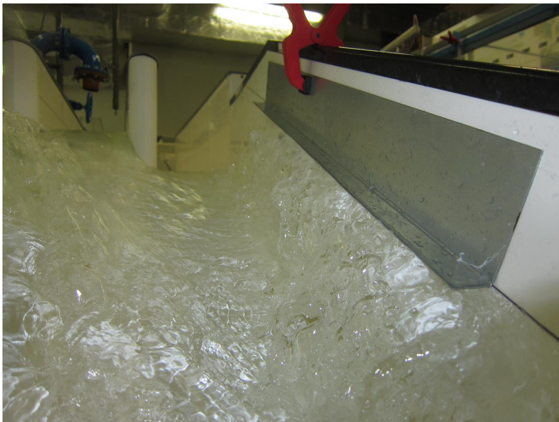
Obr. 68 Usměrnění proudu jedním z instalovaných deflektorů
