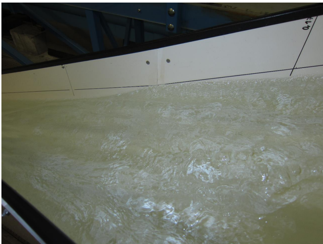
Obr. 63 Potlačení výstupu proudu v prostoru konce konfuzoru skluzu při průtoku Q_{10\,000} = 1766 \text{ m}^3/\text{s}
