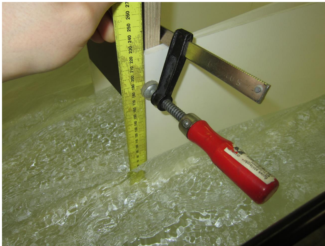
Obr. 22 Ocelová měrka použitá pro měření hloubky proudu
